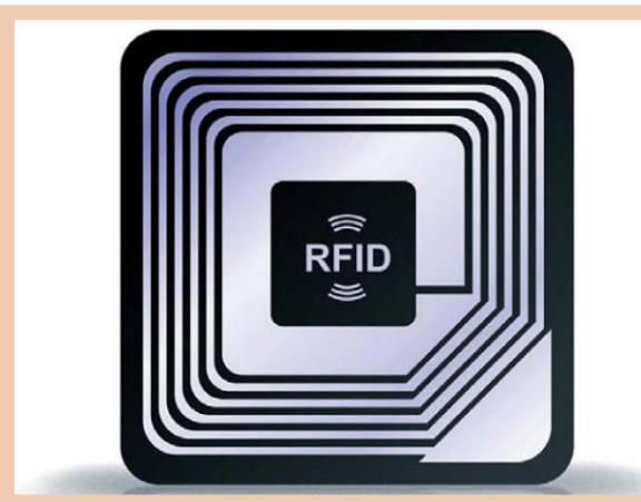
способ автоматической идентифи-кации, в котором посредством радио-сигналов считываются или запи-зываются данные, хранящиеся в так называемых транспондерах, или RFID-метках. Первая демонстрация близких к современным RFID была проведена в 1973 г., но само разви-тие этих технологий получило тол-чок в 1999 г.
